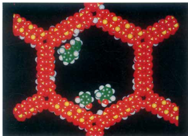
Abb. 30. Links: Graphische Darstellung der Vorgehensweise, mit der van Bekkum et al. [225] Formselektivität in organische Prozesse wie die Fries-Reaktion einführen, wobei sie neuartige, großporige (Durchmesser 20 bis 50 Å), mikrokristalline Siliciumdioxid-Festkörper [222, 223] einsetzen. Diese hexagonale Pore mit einem Durchmesser von 31 Å beherbergt eine Reihe von funktionalisierten Arenen, die zu Beginn teilweise über freie Si-OH-Gruppen an den Wänden der Pore verankert sind (2,6-Dimethylbenzoesäure und Resorcin, die durch eine Fries-Reaktion ein Benzophenon-Derivat ergeben). Rechts: DAF-2 (Davy-Faraday 2) ist ein neu konzipiertes Molekularsieb, in welchem Cobalt (grün) und Phosphor (purpur) im Verhältnis 1:1 die tetraedrisch gebundenen Ionen des Gerüsts sind (rot: Sauerstoff) [222].
