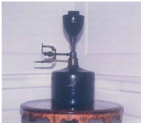
Abb. 1. Dieses Feuerzeug erhielt Michael Faraday in den späten zwanziger Jahren des letzten Jahrhunderts von Döbereiner, dem Erfinder. Im Döbereiner-Feuerzeug, der ersten kommerziellen Nutzung der heterogenen Katalyse, wird durch Einwirkung von Säure auf Zink ein Wasserstoffstrom erzeugt, der auf feinverteiltes Platin gerichtet wird. Der Katalysator wird weißglühend und entzündet so den Wasserstoff, der mit dem Luftsauerstoff zu Wasser verbrennt.
